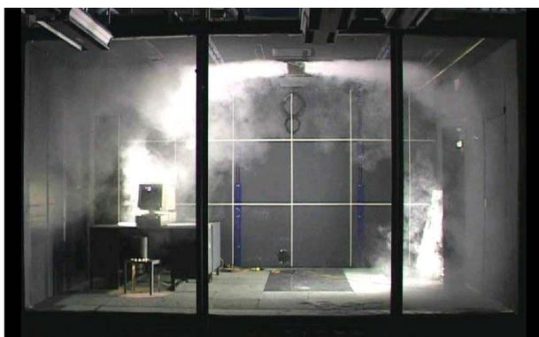
Raumströmungsversuch mit dem HDF-Gerät im LTG Labor (LTG Ingenieur-Dienstleistungen)
