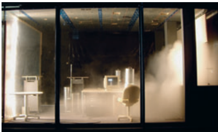
6. Een kritieke koellastsituatie in een model kantoorruimte in het laboratorium voor luchtstromingstesten in Stuttgart, waarbij de instelling van de units worden geoptimaliseerd en in documenten beschreven om een soepele renovatie te kunnen garanderen.
