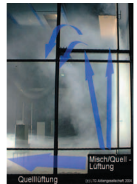
Fig. 2: Stromingsvisualisering van beide stromingsvormen in het proeflaboratorium. van LTG Aktiengesellschaft te Stuttgart
