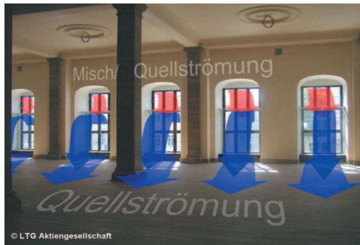
Fig 8: Stromingsconcept van twee stromingsvormen; verdringingsstroming voor de verse lucht verdeling + meng/verdringing voor het verwarmen/koelen/bevochtigen en ontvochtigen
