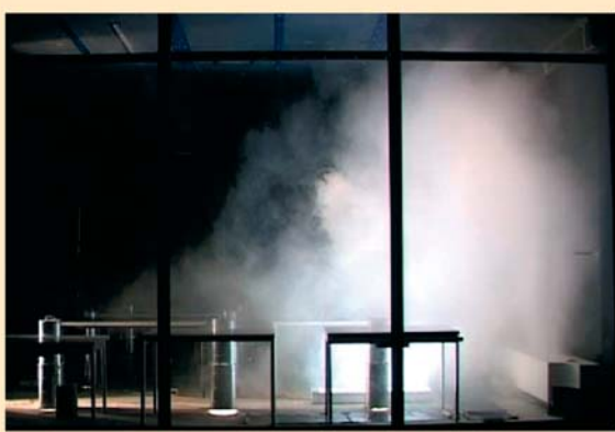
Luchtstroming in de ruimte bij verdringingsventilatie.
