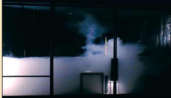
Luchtstroming in de ruimte bij meng-verdringing.
