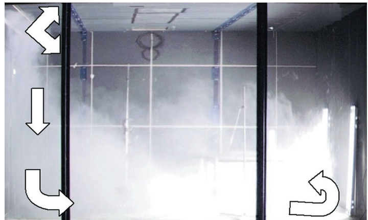
4. Rookproefopname met 3 wandluchtdoorlaten, elk 70 m 3 /h en 8 K ondertemperatuur van de lucht.
